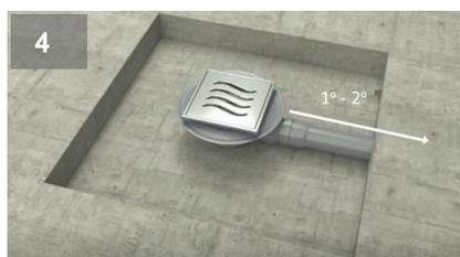
4 Присоедините канализационную трубу к выходу трапа с уклоном не менее 1-2 градусов от трапа.
