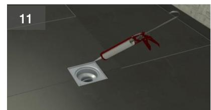
11 Между карьером решетки и напольным покрытием нанесите слой герметика (например, силикон).
