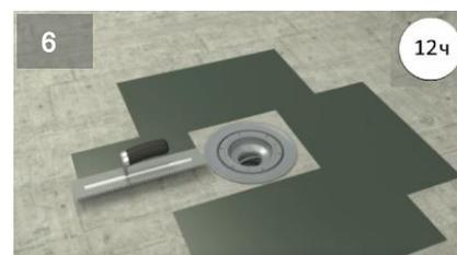
6 Нанесите первый слой гидроизоляционного поверхностного герметика до уровня карьера решетки. Минимальное время для высыхания первого слоя - 5 часов, оптимальное - 12 часов.
